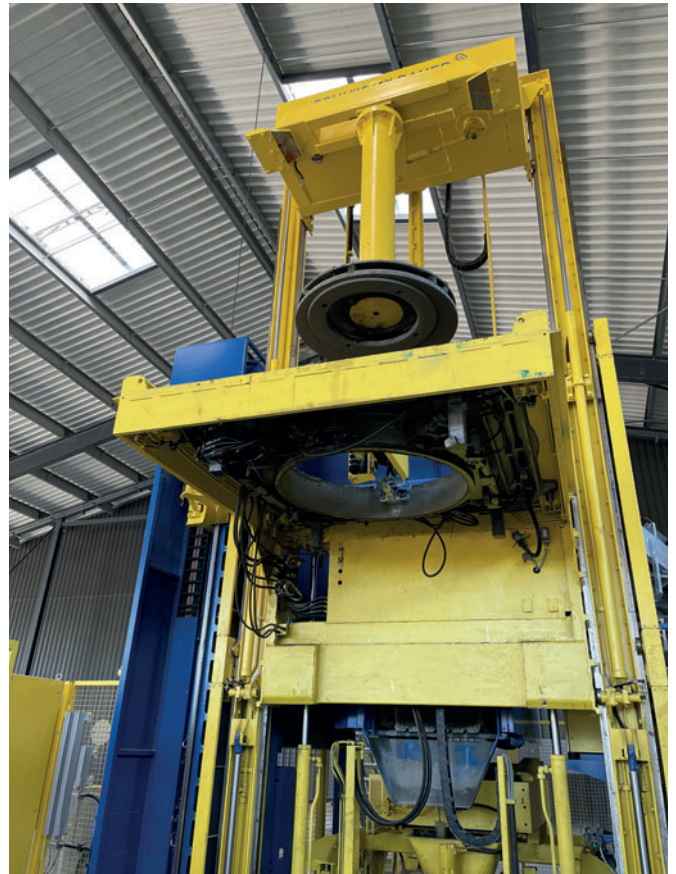
На линии Magic 2 установка анкеров выполняется также полностью автоматически
