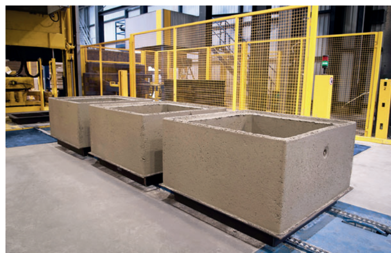
На заводе CRP SAS на линии Magic 1501 выпускаются элементы люков как прямоугольного, так и круглого сечения с несколькими вариантами по монтажной высоте
