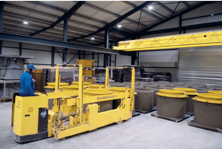
Три электрические передаточные тележки транспортируют изделия в зону выдержки и затем в систему паллетирования
